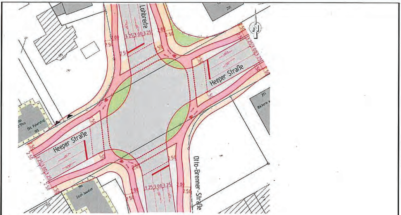
Abbildung 5: Knotenpunktform „Protectet Intersection“ PIS, Otto-Brenner-Str. / Lohbreite
